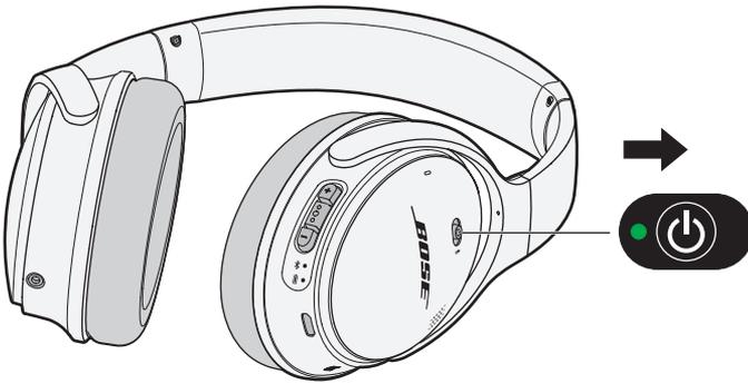
バッテリーインジケータ
